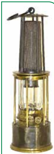
Lampe Mueseler, grand format pour l'éclairage fixe des charges. Coll. MMIL.
